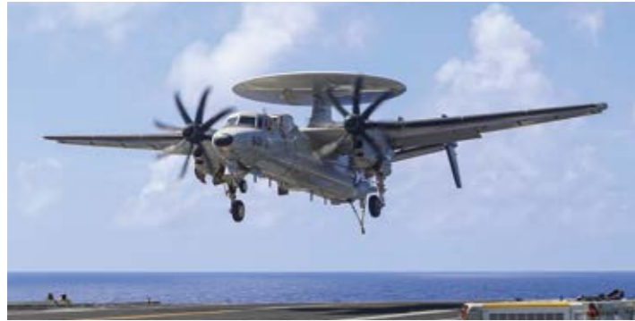
空中早期警戒&管制機 E-2D ノースロップ・グラマン社製のE-2Dは高度数千メートルを飛行し、上空から、地上設置の対空レーダーよりも遥かに遠い、周囲数百キロメートルをレーダー監視することが可能。警戒だけでなく管制機能も持つ。写真はアメリカ海軍の早期警戒機E-2D(写真:US Navy)
