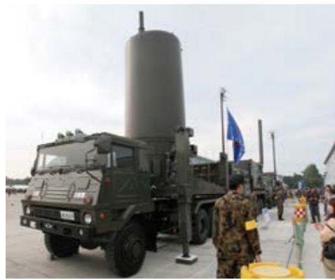
移動式警戒レーダー 移動式警戒レーダーの役割は、車載して任意の地点に展開し、そこでレーダーによる監視を行うこと。写真は航空自衛隊のJ/TPS-102移動式3次元レーダー装置。アクティブ・フェーズド・アレイ・アンテナを内蔵し、全方位・仰角を電子走査する。得た情報はネットワークシステムへと提供される(写真:編集部)
