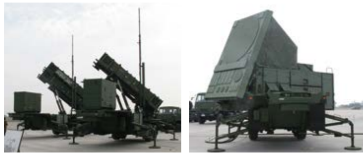
地対空ミサイル ペトリオットPAC-3 PAC-3の役割は、敵の航空機や巡航ミサイルを撃墜すること。ミサイル本体、レーダー装置、射撃管制装置、発射機、アンテナマスト・グループ等からなる。写真は航空自衛隊のレーダー装置(右)と発射機(左)。レーダー装置は、多機能フェーズド・アレイ・レーダーで複数目標の同時捕捉が可能。発射機には16発のアクティブ・レーダー誘導ミサイルが装填されている(写真:編集部)
